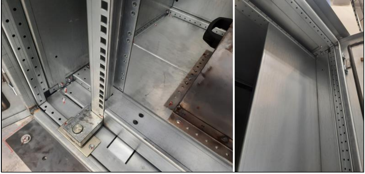
Resim 5. Kapı Bağlantı Detayları
