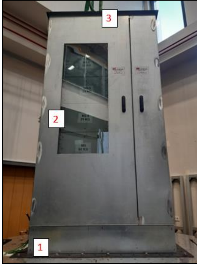
Şekil 2. UUT üzerindeki ivmeölçer lokasyonları
