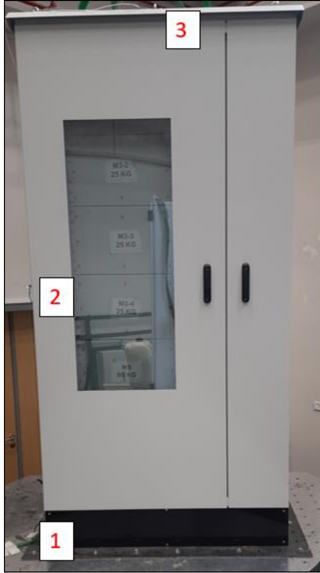
Şekil 2. UUT üzerindeki ivmeölçer lokasyonları
